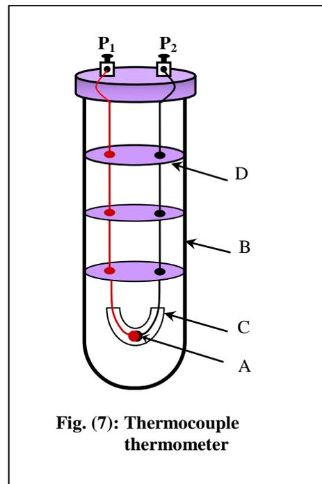
Fig. (7): Thermocouple thermometer
